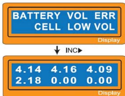
Процессор определил нарушение напряжения на одном из элементов батареи.
