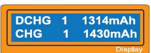
После окончания всех операций заряда/разряда, ЗУ оповещает о завершении звуковыми сигналами. На экране можно увидеть результаты работы ЗУ: какая емкость была выдана аккумулятору и какая забрана. Нажатием "INC" и "DEC", можно посмотреть результат по каждому циклу.
