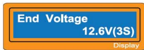
Показывает конечное напряжение, при достижении которого, процесс заряда останавливается.
