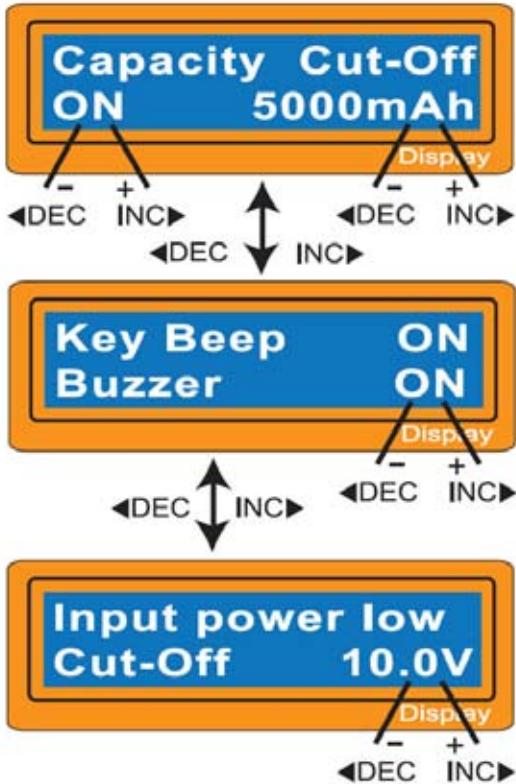
**Отсечка по емкости (при заряде).** Здесь можно выставить отсечку по емкости (до 5000 мА/ч), это позволит прерывать процесс заряда по достижении заданной емкости. Это ограничение можно отключать, что позволит заряжать батарею любой емкости.
