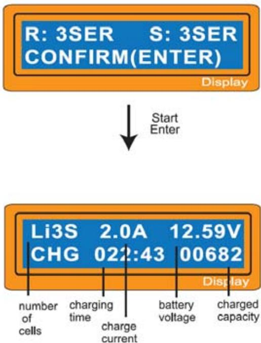
Этот экран показывает параметры количества элементов выбранных пользователем и определенным микропроцессором.
