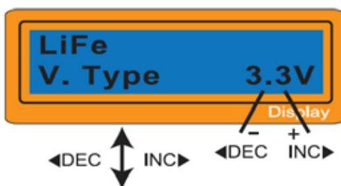
Данный экран отображает номинальное напряжение для литиевой батареи. ЗУ работает с тремя типами батарей и для каждого типа своё напряжение:
