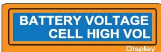
Напряжение одного из элементов батареи слишком высокое. Пожалуйста проверьте каждый элемент по отдельности.
