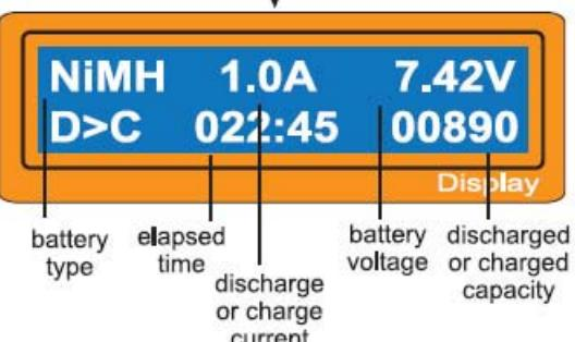
В этом режиме Вы можете выбрать последовательность выполнения операций (заряд->разряд или разряд-> заряд), а также количество циклов (от 1 до 5). Эта программа также учитывает процедуру отсечки по температуре (при подсоединенном термодатчике), настраиваемую в общих настройках.
