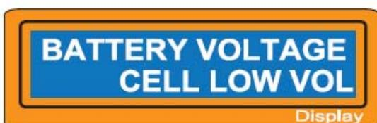
Напряжение одного из элементов батареи слишком низкое. Пожалуйста проверьте каждый элемент по отдельности.
