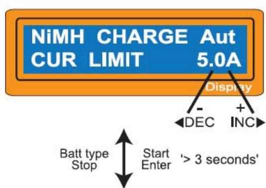
Эта программа предназначена для заряда и разряда никель-металгидридных и никель-кадмийевых батарей, применяемых для радиоуправляемых моделях и страйкбольных приводах. Нажмите на кнопку “START/ENTER” и выставите необходимый ток зарядки кнопками “INC“ и “DEC“. Нажмите снова “START/ENTER” для запоминания параметра тока. В данном ЗУ есть два режима для заряда никелевых батарей:
