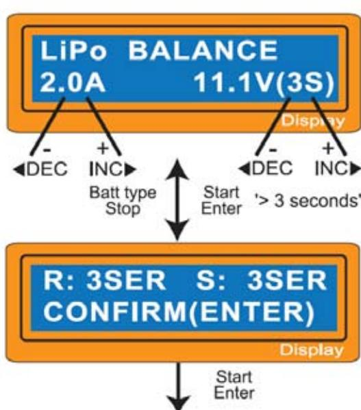
На этом экране слева сверху отображается тип заряжаемой батареи, ниже - текущий ток заряда. После установки параметров тока и напряжения, нажмите кнопку “START/ENTER“ и удерживайте её нажатой в течение 3-х секунд, до тех пор пока не прозвучит мелодия.
