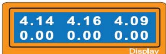
Если батарея подсоединенна к балансиру зарядного устройства (на правой боковой стенке ЗУ), то можно наблюдать изменения напряжения на каждом элементе в режиме реального времени. Балансир позволяет контролировать до 6 элементов.
